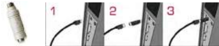
الشكل رقم (13): وصل لوحة المفاتيح بالحاسوب.
